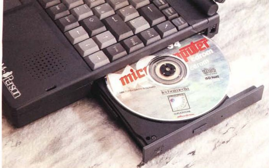
Il lettore di CD-ROM integrato. Motore e pick-up di lettura (foto a destra) sono incorporati nel carrello porta CD.
